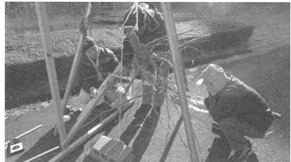
図-5. 深さ0.4m強のせん断面に位置した根のマーク付け調査の様子
