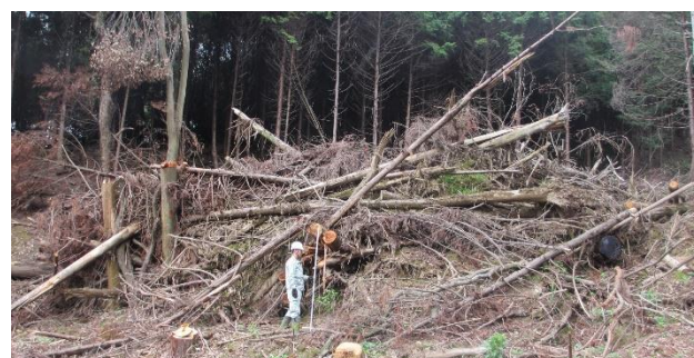
図一3. 流木がヒノキ立木と絡み合うように相互作用し崩土の運動が抑止されて形成されたダム状の堆積物 (堆積物の最大厚さは 4m 程度、写真の撮影は災害発生後 11 カ月時点で、工事の関係で堆積物前方の立木は株切された状態であることに注意が必要)
