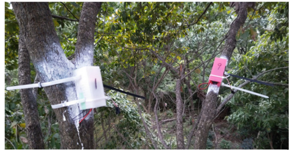
図-5. 計測ユニットの立木への設置状況 Fig. 5 Installation of the measurement unit on stand
